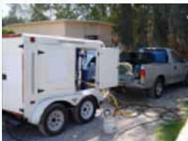
Maquina desgasificadora de alto vacío. marca: veronesa con capacidad de desmasificado de 1000 lts. por hora
