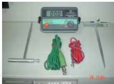
Probador de resistencia óhmica de tierra. marca: kioritsu
