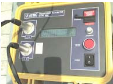
Medidor de relación de transformación. marca. Acme. modelo 8500
